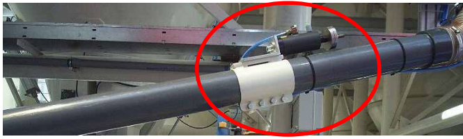
写真 3-1. 鑄物砂の閉塞・堆積の解消事例、 ピストンバイブレータ NTK18AL+2xSM16-2
