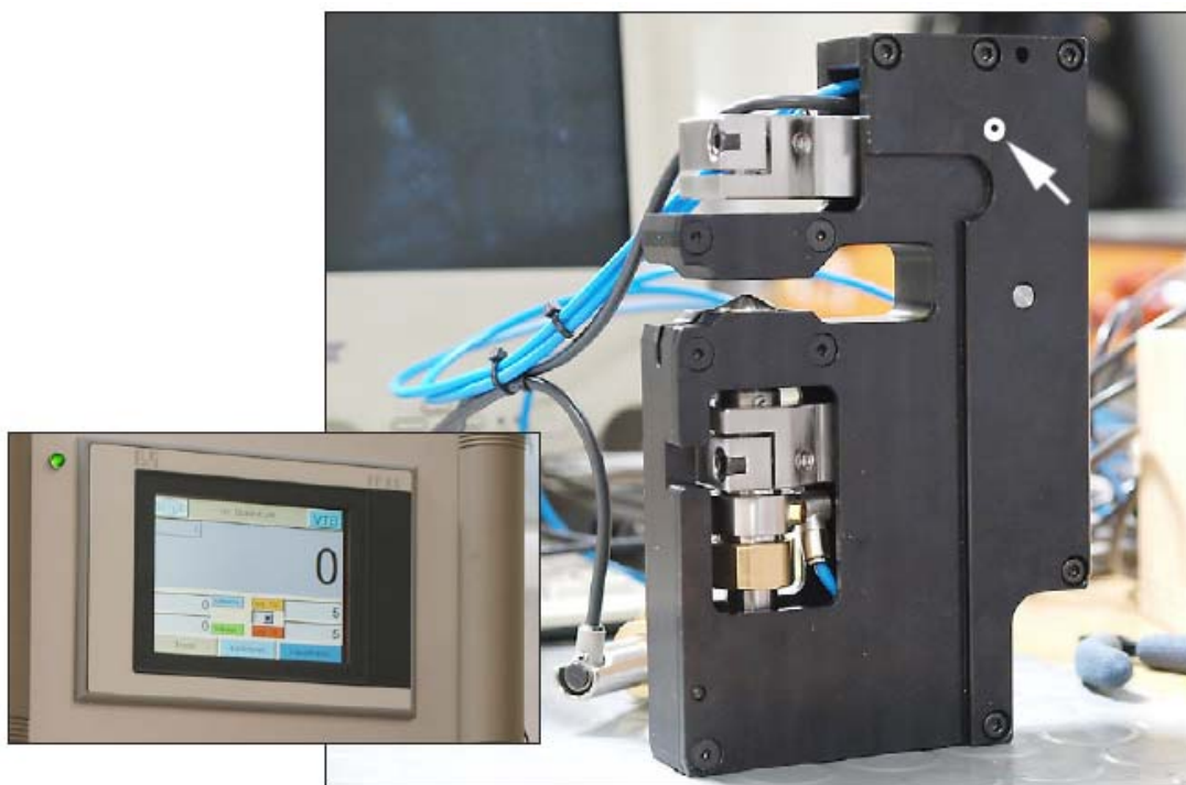
VBM 565 モジュール: 下トランスデューサーはフレームに取り付いている。上トランスデューサーは外されている。VTS パネルの指示は0を示す。矢印は調整ピンを示す。
